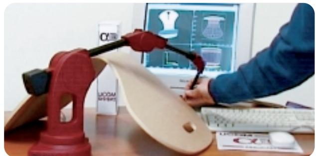
**L**as operaciones de fresado complejas son programadas por medio de CAD/CAM, que por solito es interactuada con el digitalizador tridimensional para poder detectar las formas directamente del modelo.
