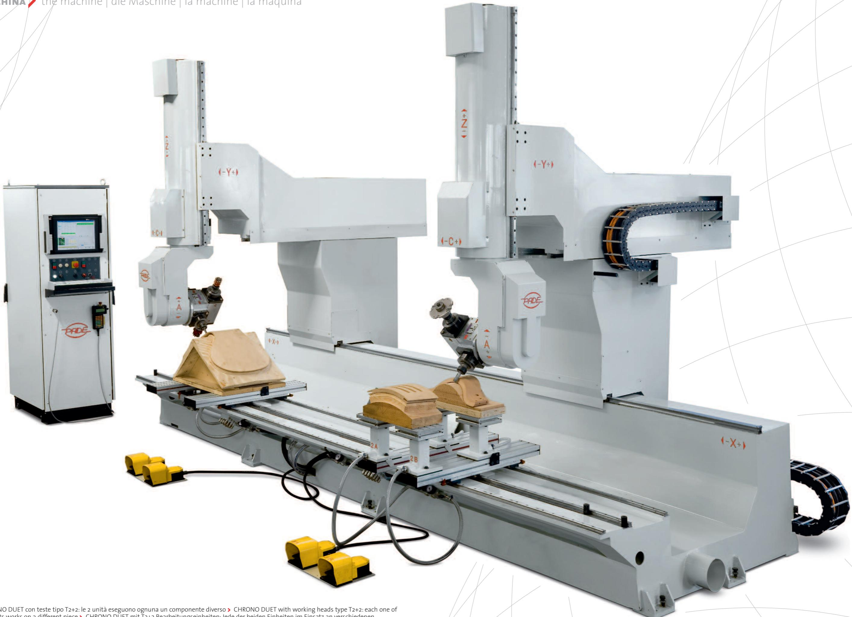
► CHRONO DUET con teste tipo T2+2: le 2 unità eseguono ognuna un componente diverso
